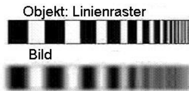
*Abb. 2.4.3-1 Kantenkontraste Objekt – Bild*
